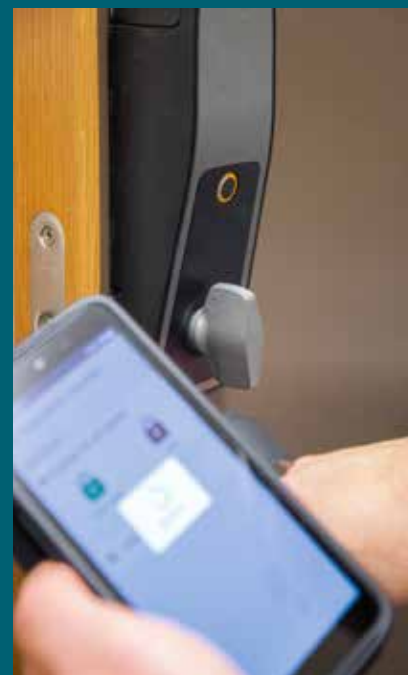
De digitala dosorna på låsvredet är mycket säkra och kan låsas både digitalt och med vanlig nyckel.
